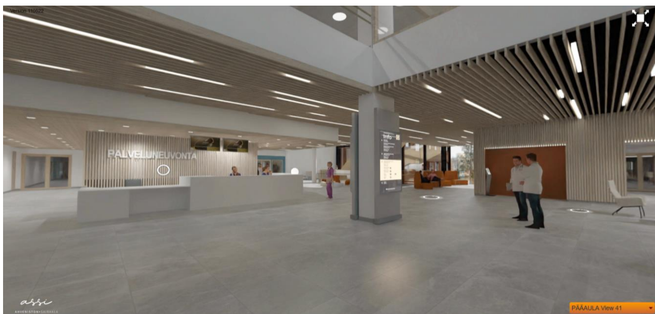
Kuvakaappaus Assin virtuaalimallista pääaulasta. Näkymä on heti pääovien jälkeen kohti Ahvenistontien sisäänkäyntiä. Kuvassa näkyy matalampia tiloja yhdistävä puulankkukatto, joka muuttuu levykatoksi korkeimmissa tiloissa. Havainnekuva: Integrated työyhteenvuoritus
